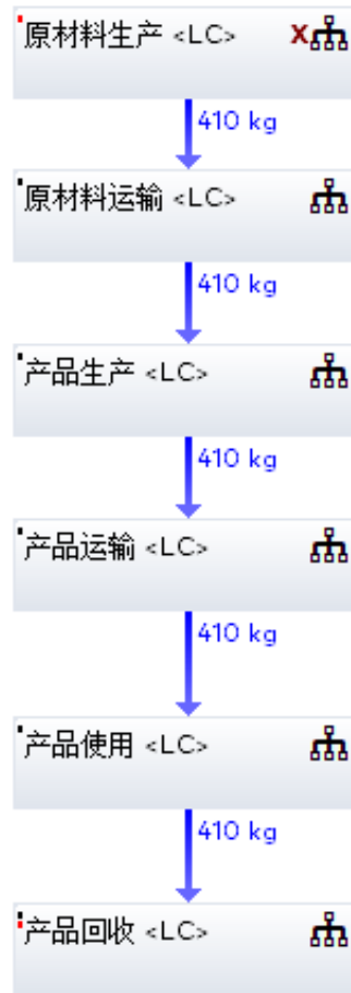
图 5.1 生产和使用 1 台 MNS 低压柜（电流 4000A）生命周期评价 GaBi 总模型
