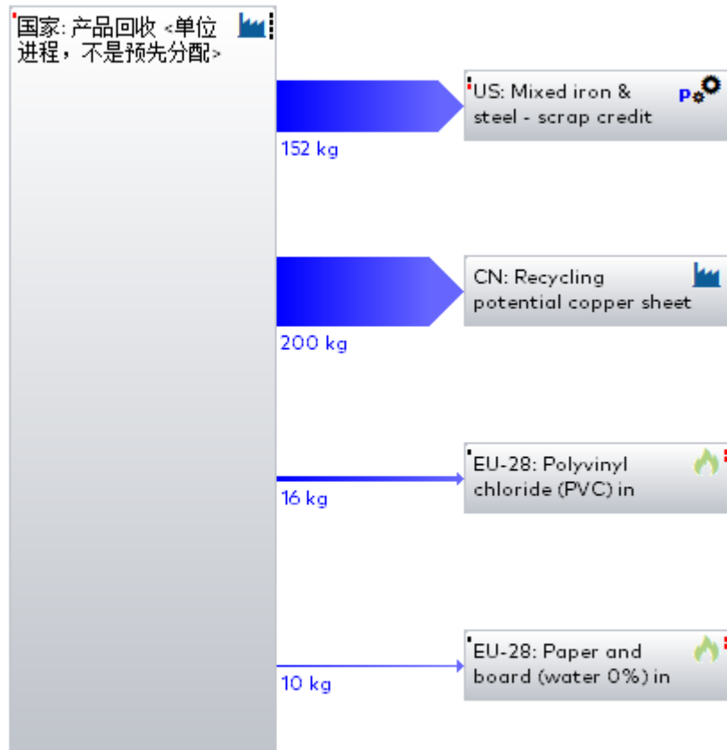
图 5.7 1 台 MNS 低压柜（电流 4000A）产品废弃回收阶段生命周期评价 GaBi
