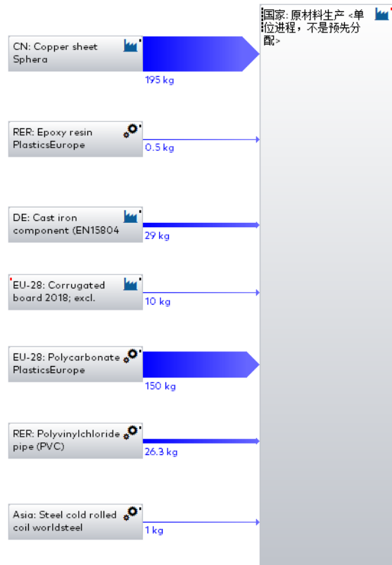
图 5.2 1 台 MNS 低压柜 (电流 4000A) 原材料生产阶段生命周期评价 GaBi 模型
