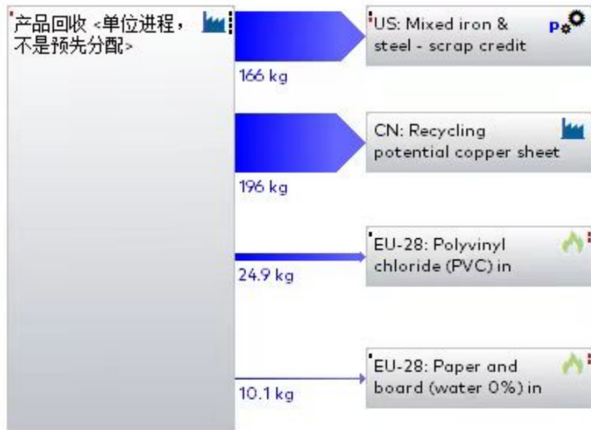
图 5.7 1 台 BlokSeT 低压柜产品废弃回收阶段生命周期评价 GaBi 模型
