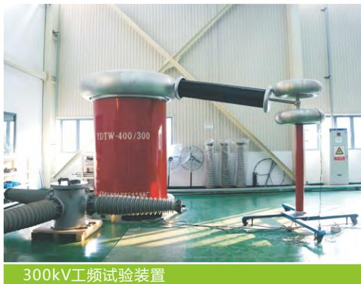
300kV工频试验装置
