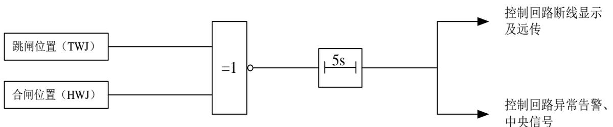
图 26 控制回路断线逻辑图
