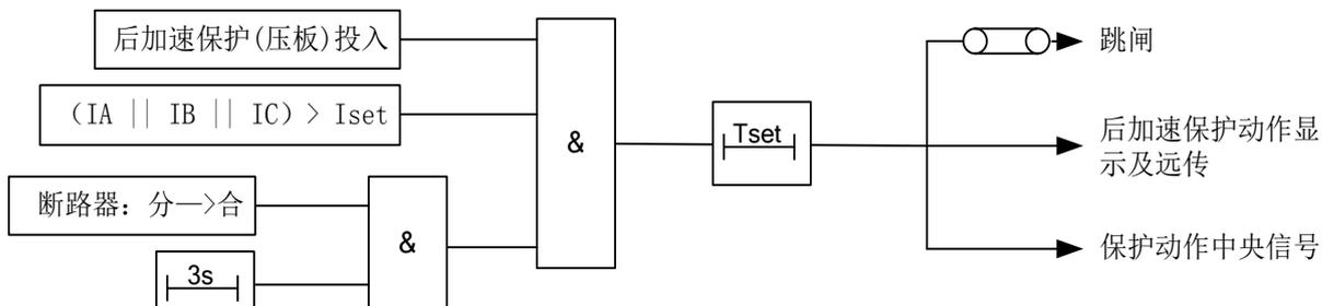
图 15 后加速保护逻辑图
