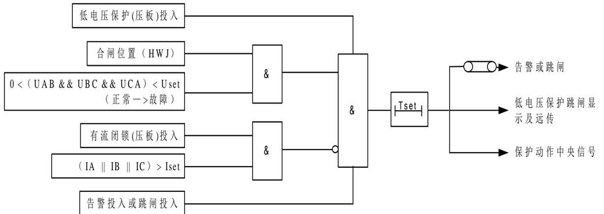
图 19 低电压保护逻辑图
