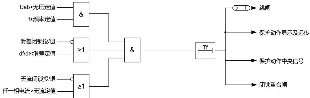
图 16 低频减载逻辑图
