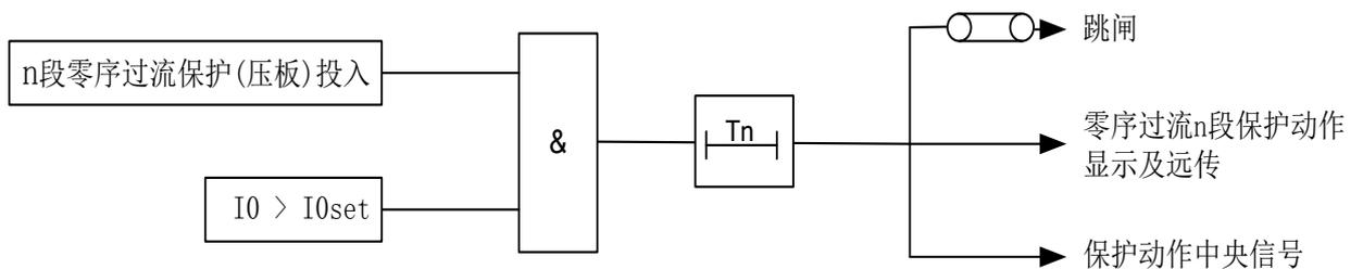
图 11 零序过流保护逻辑图
