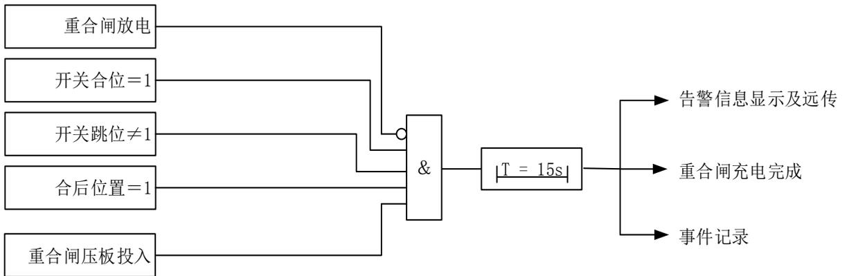
图 13 重合闸充电电条件逻辑图
