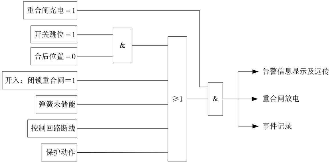
图 12 重合闸放电条件逻辑图
