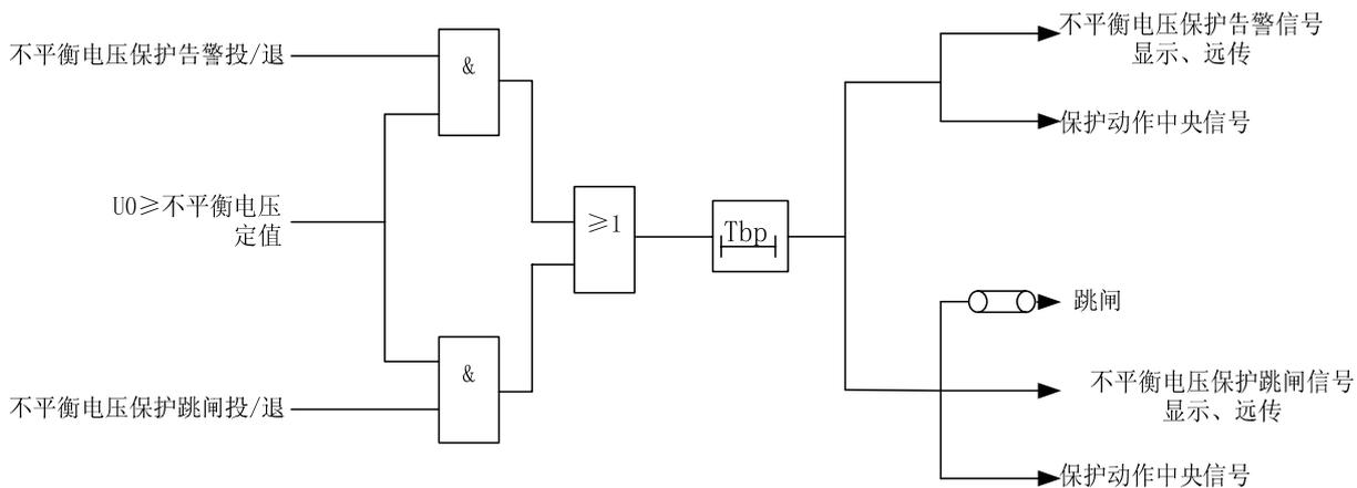
图中：Tbp为不平衡电压保护动作时限
