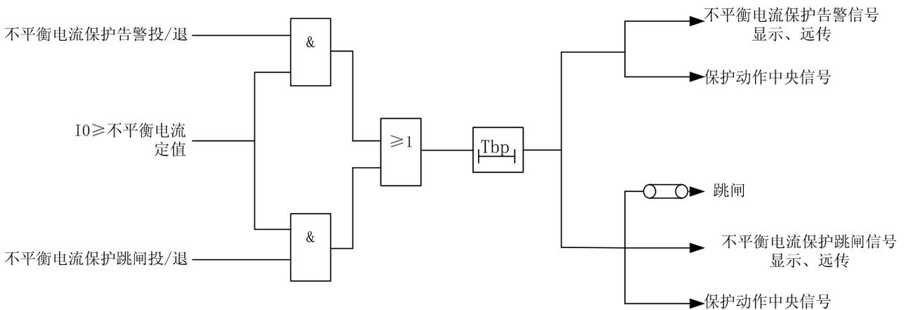
图中： $T_{bp1}$ 为不平衡电流保护动作时限
