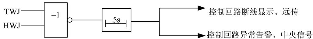
图 16：控制回路断线逻辑图
