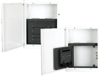
箱体为塑料或金属面板，金属底壳结构，安装(嵌墙)尺寸：300X400X115(mm)。面板采用工程塑料(ABS)或聚碳酸酯(PC)，也可采用优质冷轧钢板，表面静电喷涂处理。底壳采用优质冷轧钢板，表面静电喷涂处理。
