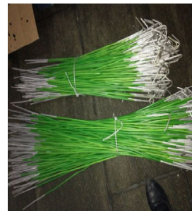
挂具、屏蔽螺母浸可剥漆
