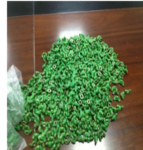
挂具、屏蔽螺母浸可剥漆
